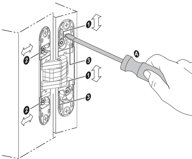
Effettuare le seguenti regolazioni una per volta con chiave a brugola da 3 mm:
